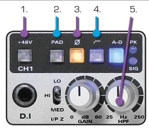
Pour vérifier la cohérence des phases dans des configurations à multiples micros, commencez toujours par placer soigneusement les micros puis enclenchez le commutateur Ø [3] sur diverses combinaisons de canaux pour trouver celle donnant la représentation la plus pleine et la plus solide des basses fréquences de la source.
