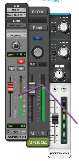
L'affichage de niveau sur l'ASP880 signalera la présence d'un signal à -28 dB FS (-10 dBu) et préviendra de potentielles saturations à -2 dB FS (+16 dBu). Toutefois, vous ne devez vous baser que sur l'enregistreur de destination pour une mesure précise.
