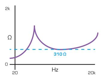
La source (microphone) et la charge (le préamplificateur de micro) forment un pont diviseur de tension qui contient des valeurs de résistance différentes pour la source à différentes fréquences, créant ainsi une réponse en fréquence variable (ou différents niveaux de sortie pour chaque partie de la courbe d'impédance du SM57) et par conséquent un changement de son peut être perçu.
